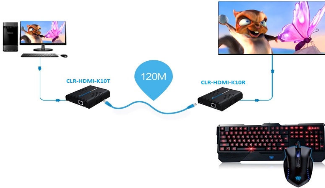
Şekil 1... Point-to-Point bağlantı. 23AWG Bare Copper Cat6 kablo ile 120m mesafeye kadar FullHD 1080P HDMI ve USB uzatılabilir. Bunun için bir adet verici (CLR-HDMI-K10T) ve bir adet alıcı (CLR-HDMI-K10R) kullanılır.
