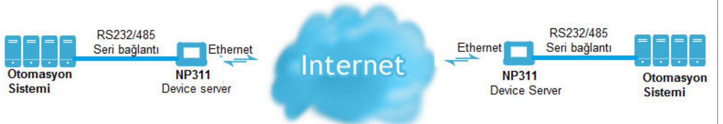
Şekil 2 : İki seri arayüzlü sistem internet üzerinden birbiriyle haberleşiyor. (RS232 veya RS485)
